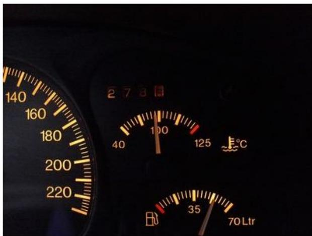
Достигнув температуры срабатывания термостата , а это 90°-95° , ( в зависимости от погрешности самого термостата ) открывается большой контур охлаждения двигателя . При этом стрелка медленно начинает отклоняться ближе к минимальному значению .
